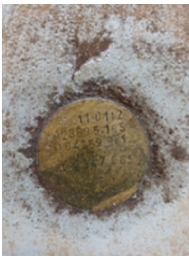
Fotografía 8. Placa de georreferenciación y nivelación del pozo pz-11-0112
